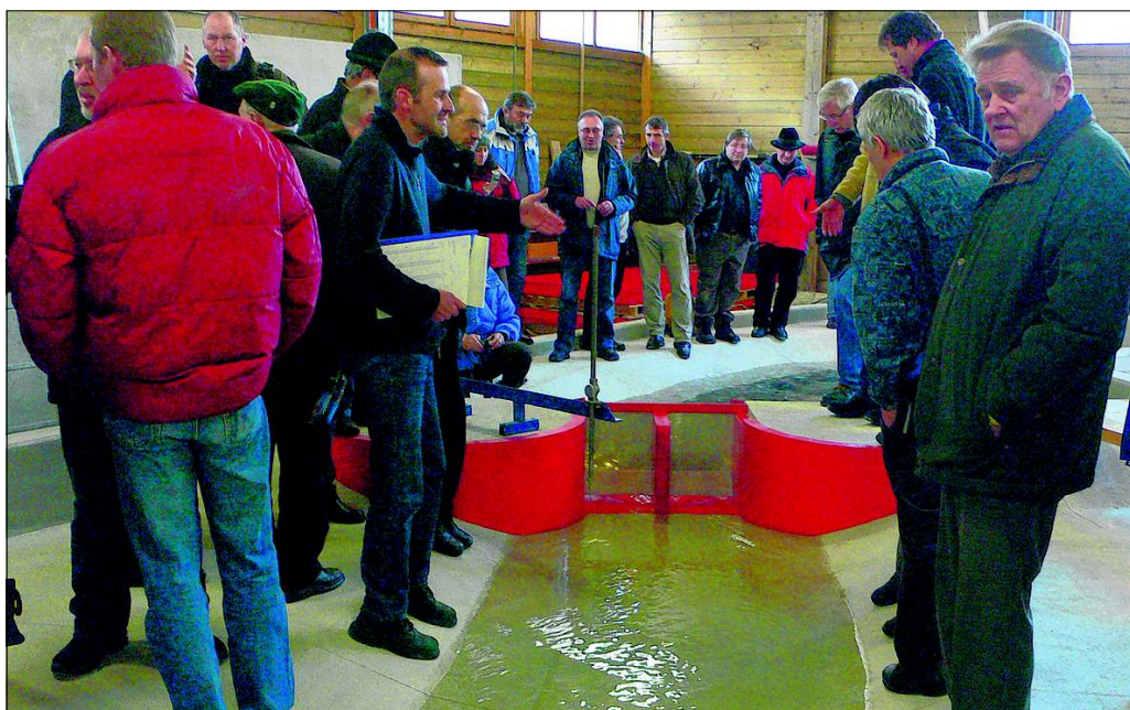
Projektleiter Arnd Hartleb von der TU München zeigte im Modellversuch, wie das Ausleitungsbauwerk für das Umgehungsgerinne für die Staustufe Pielweichs funktionieren wird. (Fotos: H. Summer)
