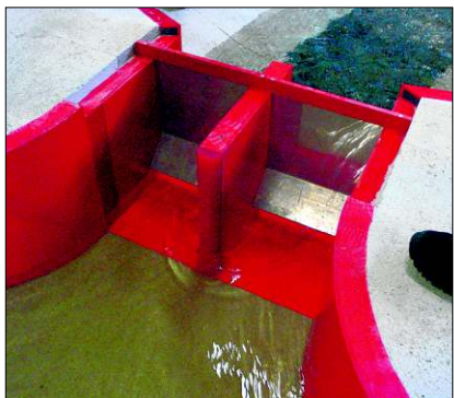
Durch den Spalt unter den beiden Drosselblenden werden je nach Wasserstand der Isar drei bis maximal 18 Kubikmeter Wasser pro Sekunde in das Ersatzgerinne strömen.
